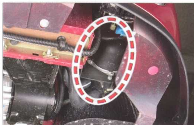
IMPLANTATION DE LA POMPE D'INSUFFLATION D'AIR
