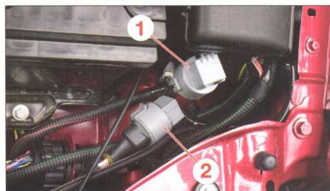
RELAIS ACCESSOIRES MOTEUR 1. Relais de pompe de direction assistée - 2. Relais de pompe pulsair
